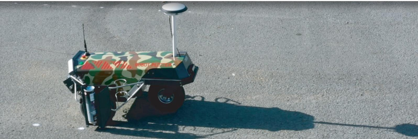
*Nos robots HERMIONE et HARRY permettent de pré marquer rapidement et précisément sur les autoroutes et voies rapides.*
